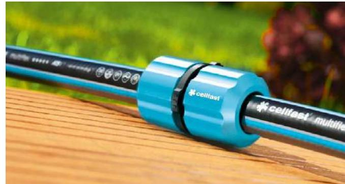
PL do trwałego połączenia dwóch końców węzy o tych samych lub różnych średnicach wydłużony mechanizm zacisku pozwala na precyzyjne połączenie z wężem ergonomiczny kształt umożliwia pewny chwyt oraz wygodę użytkowania tworzywo PC/ABS
