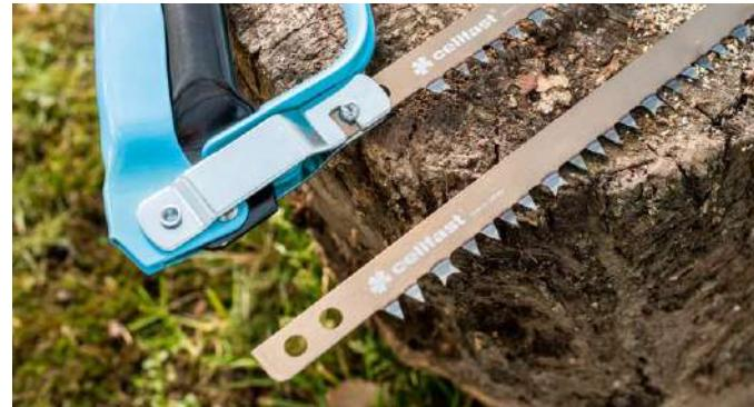
PL wysokiej jakości brzeszczoty przeznaczone do cięcia różnych rodzajów drewna: świeżego - użebienie strugające lub suchego - użebienie grupowe wykonane z wysokiej jakości stali węglowej C75S indukcyjnie hartowane zęby pozwalają na pewne i szybkie cięcie, jak również ograniczają zapychanie się pyły dostępne w dwóch długościach:
