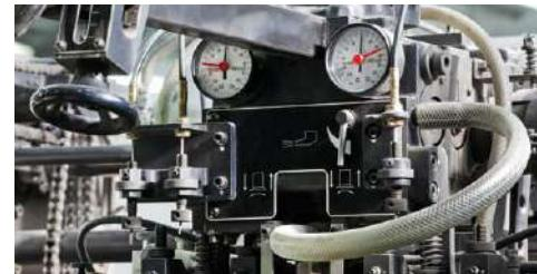
PL wąż PVC ze wzmacnieniem tekstylnym przeznaczony do przesyłu pod ciśnieniem środków ochrony roślin, powietrza, lekkich chemicznych substancji spożywczych zgodnie z dyrektywą Reg. (EU) 10/2011 dla symulantów A-B-C zakres temperatur roboczych -10/+60°C nie zawiera ftalań certyfikat bezpieczeństwa w wersji standard: wąż bezbarwny
